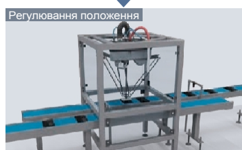
Робот (перетворення координат), корекція положення камери та інше
